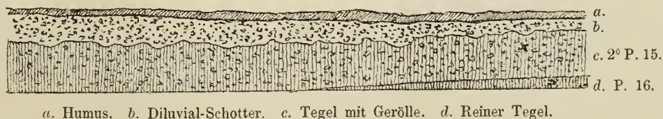
a. Humus. b. Diluvial-Schotter. c. Tegel mit Gerölle. d. Reiner Tegel.
